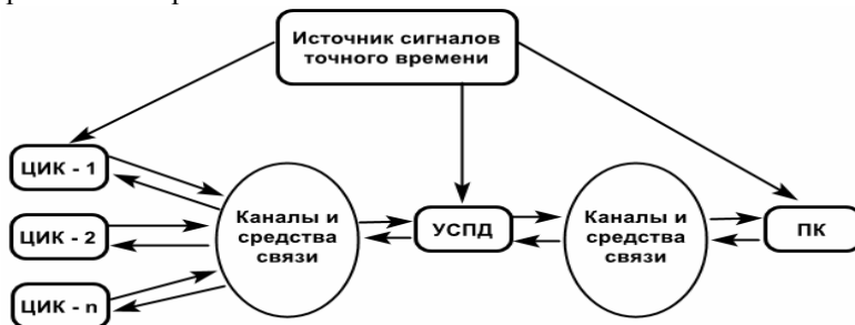
Рис 1. Структурная схема цифровой АСКУЭ с анализом ПКЭ.
