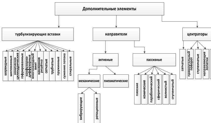
Рисунок 1 – Классификация дополнительных элементов для вертикальных распределительных устройств
