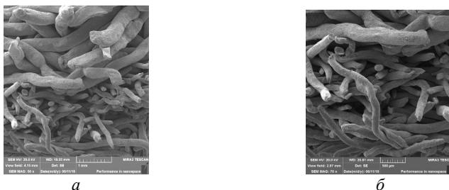
Рисунок 1 – Микроструктура хрупкого излома двухслойного ФЭ из МКО фракций  $(-0,2...+0,1)$  и  $(-0,4...+0,315)$  мм: а –  $\times 50$ ; б –  $\times 70$
