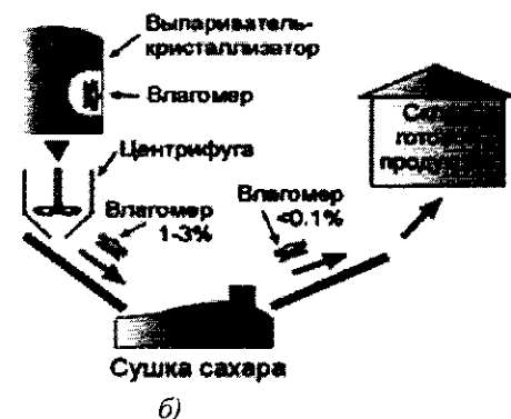
Рис.2. Влагомер "Микрорадар-114": а) внешний вид; б) вариант его установки в технологической линии производства сахара
