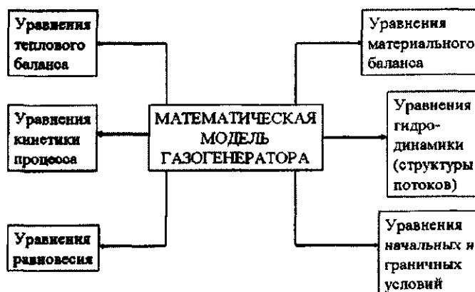
Рисунок 1. Представление возможного математического описания газогенератора [2].
