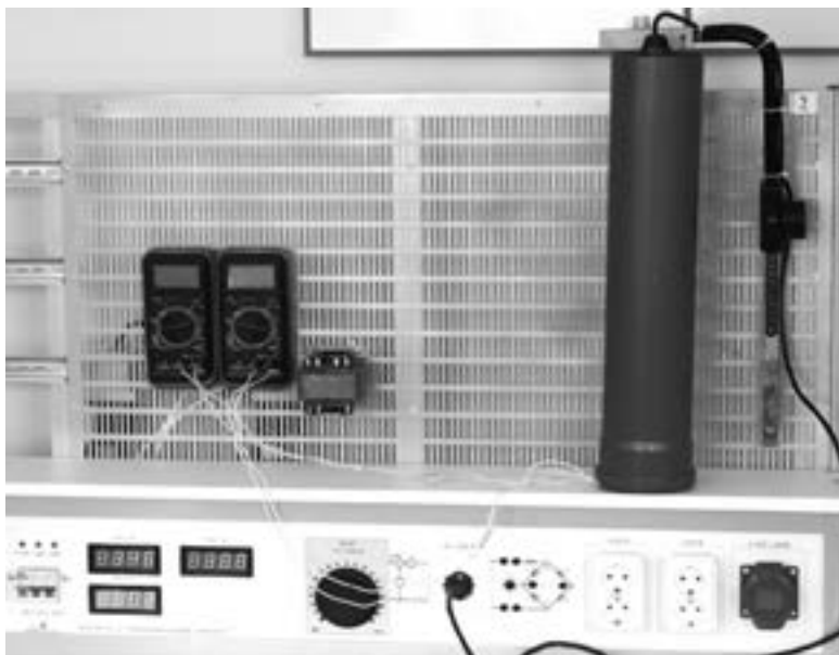
Рисунок 1 – Внешний вид доработанного лабораторного стенда с оснащением для проведения работы «Зависимость электрических свойств полупроводников от освещенности»
