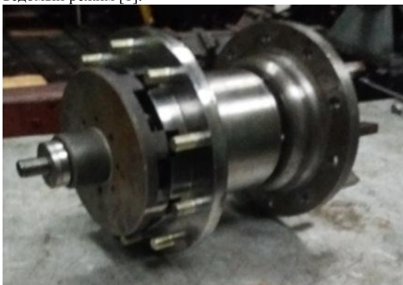
Рис. 1. Опорно-сцепное устройство задних сдвоенных колес трактора
