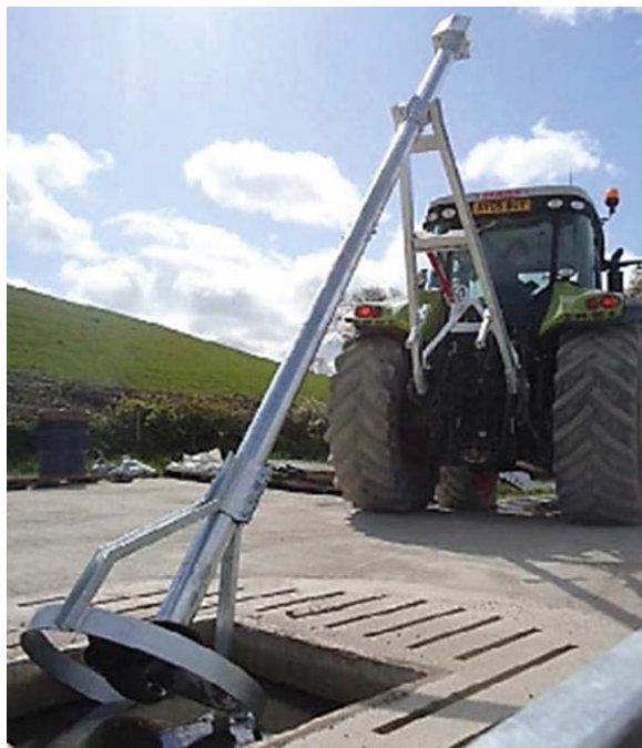
Рисунок 2. Миксер для перемешивания навоза с установленным кожухом
