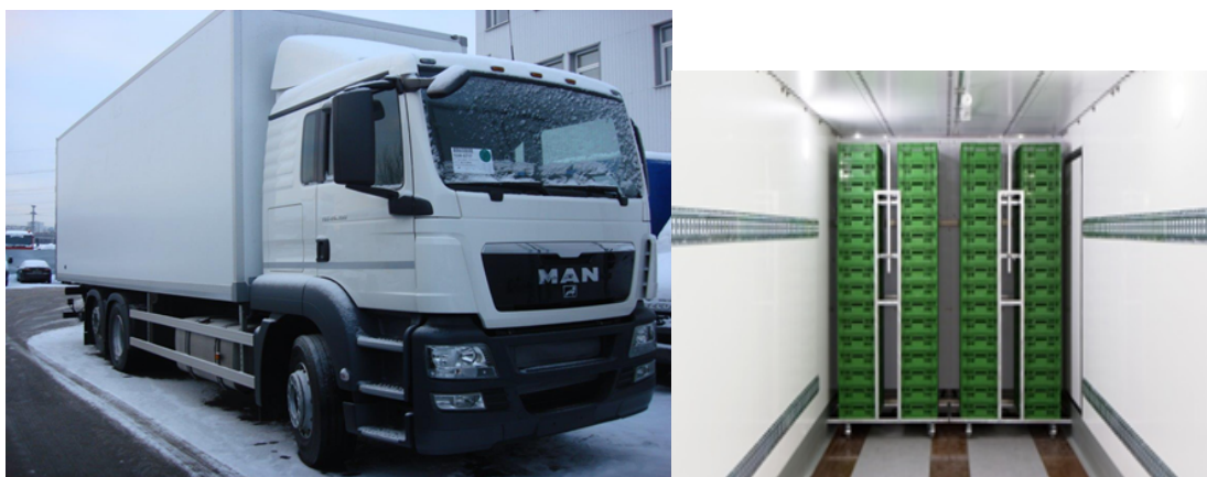
Рисунок 2. Автофургон для перевозки суточных цыплят на базе шасси МАН-TGS 26.320
