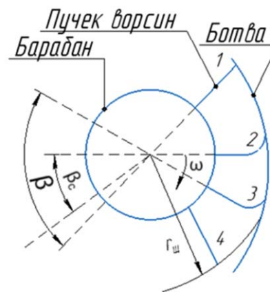
Рисунок 2. Схема взаимодействия ворса щетки с поверхностью листьев ботвы картофеля: 1 – ворс, соприкоснувшийся с поверхностью листьев ботвы картофеля; 2 – ворс, движущийся по очищаемой поверхности; 3 – ворс в момент выхода из контакта с поверхностью; 4 – ворс в момент завершения выпрямления; β – угол сектора барабана, в котором закрепленные ворсины одновременно касаются очищаемой поверхности; β с – угол между продольными осями соседних по окружности пучков ворсин; r щ – радиус траектории кончиков недеформированных ворсин
