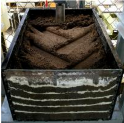
Рисунок 4. – Уплотнение почвы штампом с новой опной ведущего колеса силой 3 кН – вид сверху и спереди
