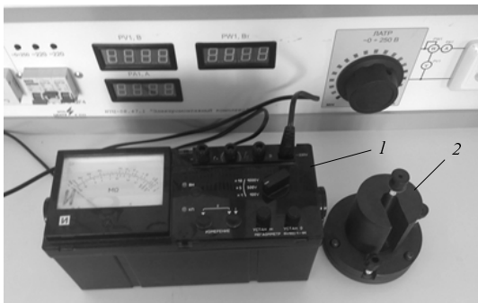
Рис. 2.3. Лабораторная установка: 1 – измерительная электродная система; 2 – мегаомметр
