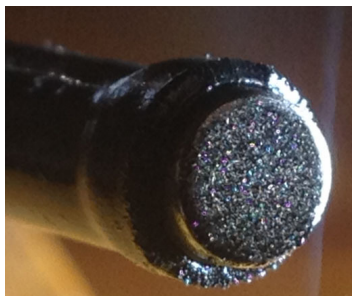
Рисунок 6 – Фотография рабочей поверхности постоянного магнита с осажденными на нем ферромагнитными частицами
