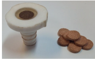
а б 1 – корпус; 2 – силиконовое уплотнение; 3 – образец; Рисунок 1 – Чертеж (а) и внешний вид (б) оснастки
