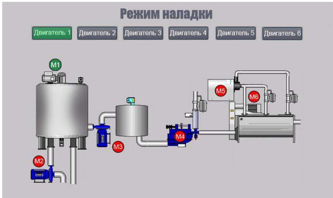
Рис. 3. Третий экран панели оператора
