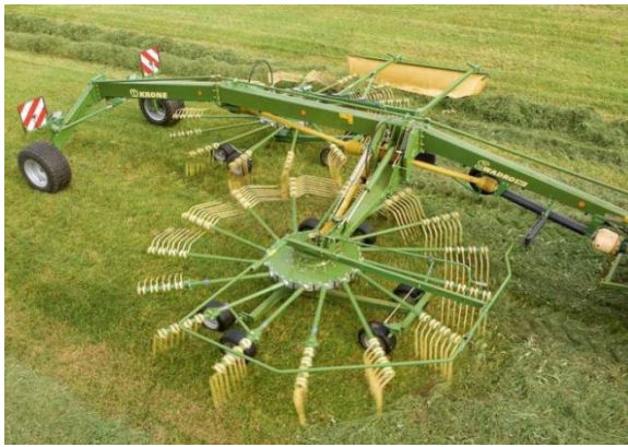
Рис. 1. Ротационные грабли-валкователи Swadro фирмы «KRONE»
