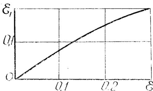
Рис. 5. Зависимость между деформациями колеса и торфяного грунта в зоне нагрузки.
