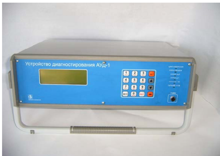
Рисунок 1. Внешний вид прибора для диагностирования асинхронных двигателей
