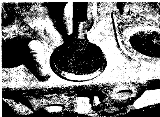
Рисунок 1 – Нагар на выпускном клапане двигателя
