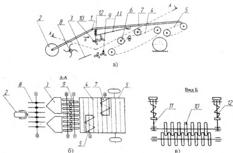
Рис. 1. Машина для уборки клубней топинамбура; а - вид сбоку; б - разрез А-А; в - вид Б
