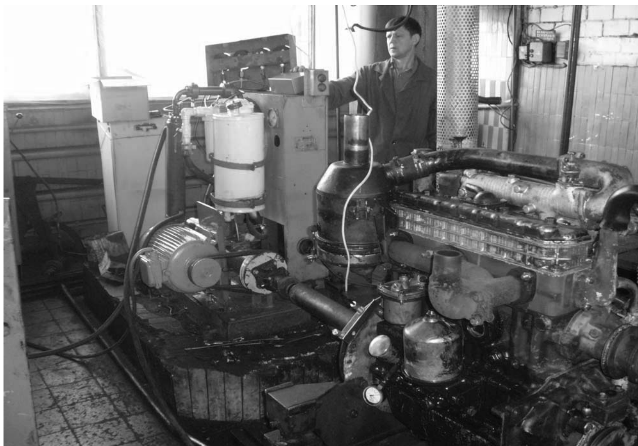
Рисунок 1. Экспериментальный образец электрогидравлического обкаточно-тормозного стенда
