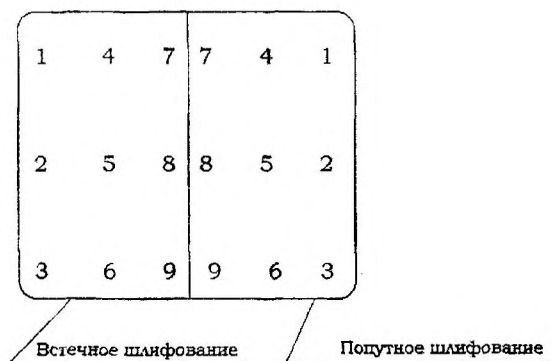
Рис. 1. Схема проведения испытаний твёрдости образца
