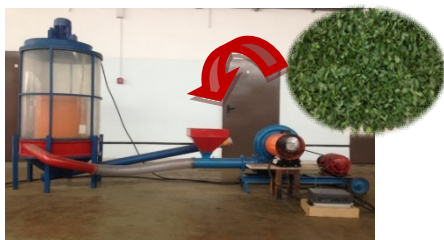
Рисунок 1. Сушильная установка с тепловентилятором электрическим для подогрева воздуха
