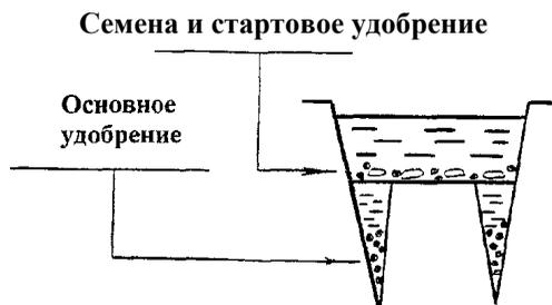
Рисунок 2 – Схема способа посева, выполняемая сошником
