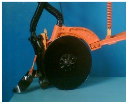
Рисунок 3 – Комбинированный двухдисковый сошник
