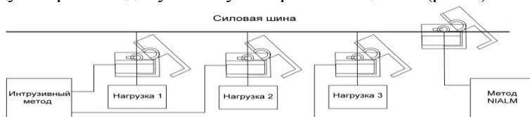
Рисунок 1. Метод неинтрузивного контроля нагрузки
