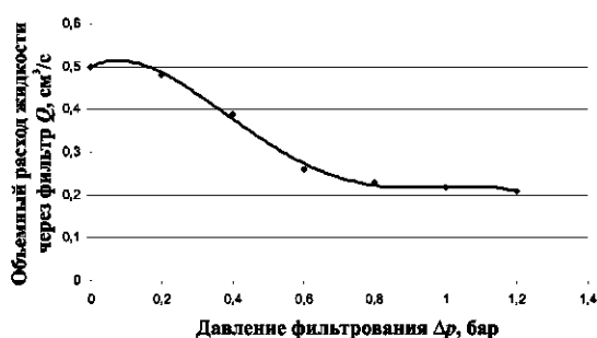
Рис. 3. Зависимость объемного расхода жидкости (воды) Q через слой осадка площадью 78 см 2 от давления фильтрации, при котором сформирован осадок
