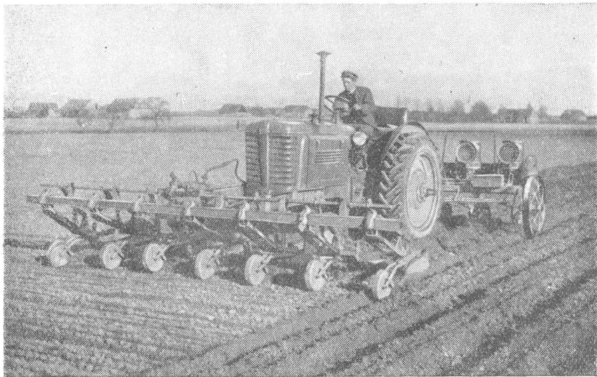
Рыс. 4. Камбінаваны аграгат з культыватара-акучніка і навясной сеялкі для нарэзкі барознаў і сяўбы гароднінных культур на грабнях.
