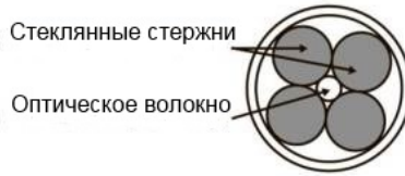
Рис. 16. Соединение оптических волокон с помощью четырехстержневых направляющих
