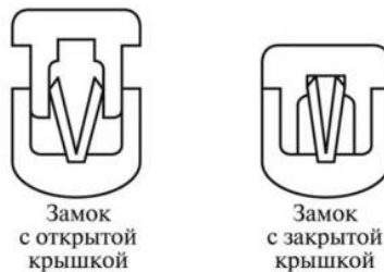
Рис. 19. Соединение оптических волокон с помощью замка Fibrlock
