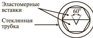
Рис. 17. Соединение оптических волокон с помощью эластомерного сростка
