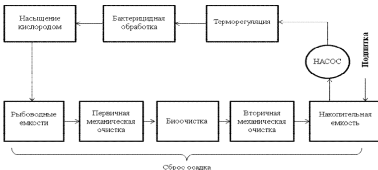
Рисунок – Типовая структурная схема циркуляционных установок
