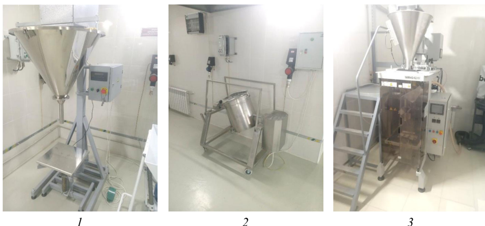
Рис. 4. Линия по производству сухих смесей: 1 – дозатор весовой электронный со шнековым питателем; 2 – смеситель для приготовления сухой смеси исходных компонентов; 3 – дозирочно-фасовочный автомат
