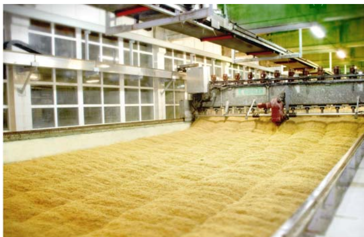
Рис. 2. Грядка проращивания солода на ОАО «Белсолод» Fig. 2. Malt germination bed at JSC “Belsolod”
