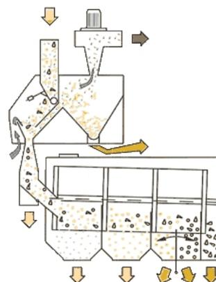
**Рисунок 70 – Сепаратор Zanin PRA и схема его работы**
