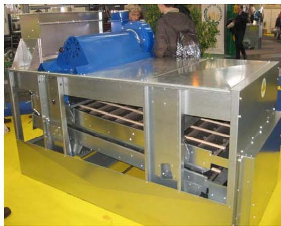
**Рисунок 76 – Машина первичной очистки Neugro UNI-SEED**
