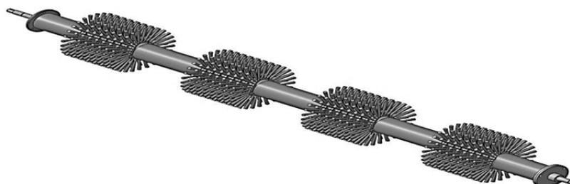
Рисунок 2 — Щеточный барабан для удаление сорной растительности механическим способом.
