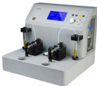
Рисунок 1. – Аналитические феррографы: а – YJF-3 Oil; б – YTF-8
