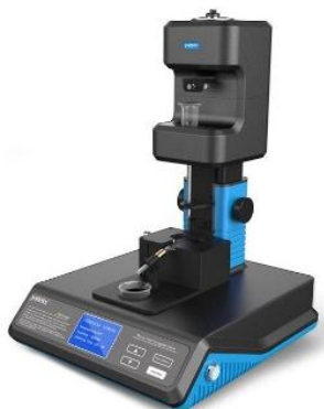
Рисунок 1. – Аналитические феррографы: а – YJF-3 Oil; б – YTF-8
