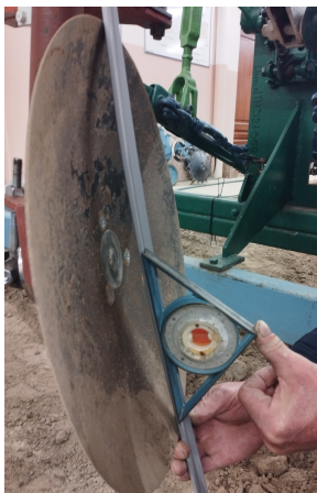
Рисунок 4. – Определение угла крена уровнем – угломером
