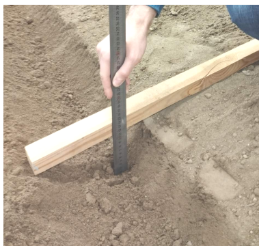
Рисунок 6 – Замер глубины обработки почвы
