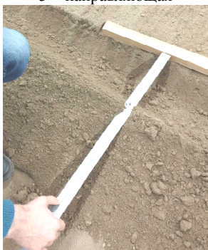
Рисунок 5 – Замер дальности отбрасывания почвы
