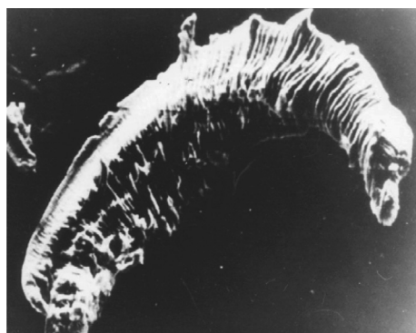
Рис. 7. Фотография стружки при микрорезании единичным абразивным зерном с наложением магнитного поля
