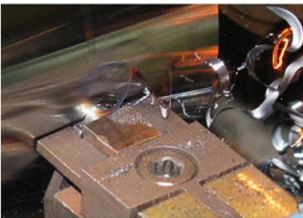
Рис. 1. Обработка детали из закаленной стали резцом с рабочей частью из сверхтвердого композита «борсинит»
