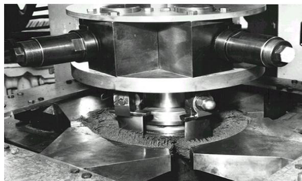
Рис. 3. Установка для МАО лопаток ГТД
