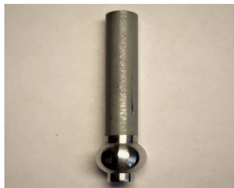
Рисунок 3 – Фотография перекидного переключателя коммутационной аппаратуры после МАО
