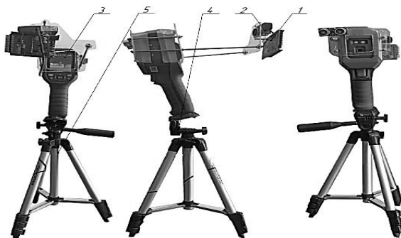
1 – кронштейн крепления; 2 – видеокамера; 3 – тепловизор; 4 – регулятор угла наклона тепловизора; 5 – штатив Рисунок 1. Аппаратная реализация системы биометрической идентификации предмаститного состояния вымени дойного стада
