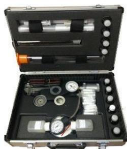
Рисунок 3 – Портативная лаборатория анализа масел и топлив ПЛИАМ-3
