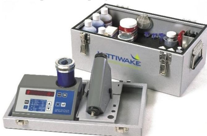
Рисунок 4 – Портативная лаборатория *Kittiwake* для анализа качества смазочных материалов и топлив
