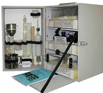
Рисунок 2 – Внешний вид судовой экспресс-лаборатории топлива и масла СЛТМ-2
