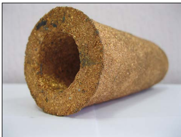
Рис. 2. Внешний вид двухслойного волокнутого фильтрующего элемента
