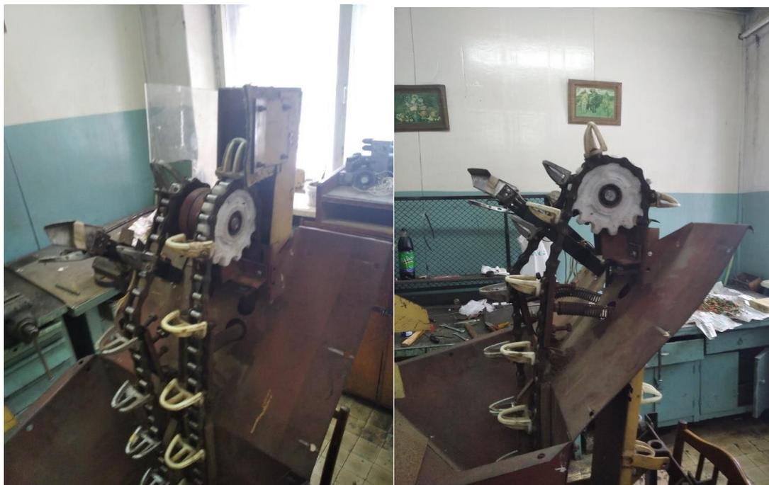
Рисунок 3 – Монтаж звездочки на лабораторной установке
