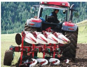
Рисунок 1 – Пластиковый отвал и работающий плуг
