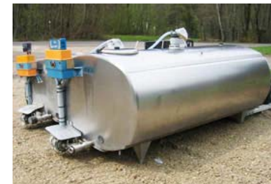
Рис. 3.51. Ванны-охладители молока Alfa Laval SCO закрытого (а) и открытого типа (б), объемом 1500 и 1250 л соответственно
