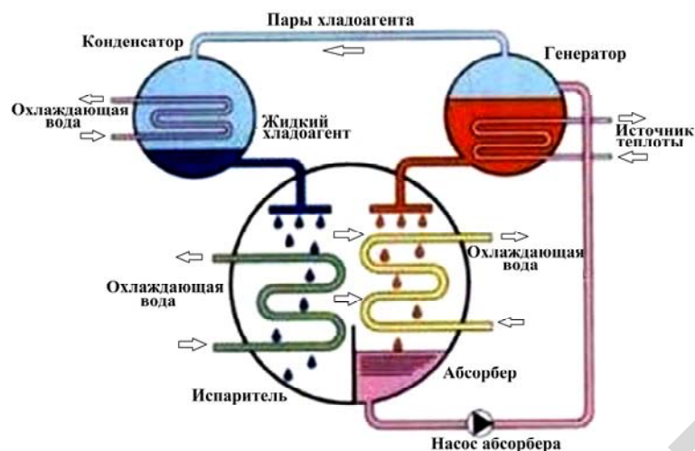
Рис. 3.32. Рабочий цикл в абсорбционном чиллере
