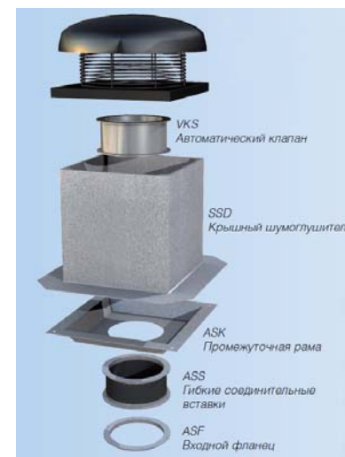
Рис. 4.62. Пример монтажа крышных вентиляторов серий DVS , DHS и DVSI
