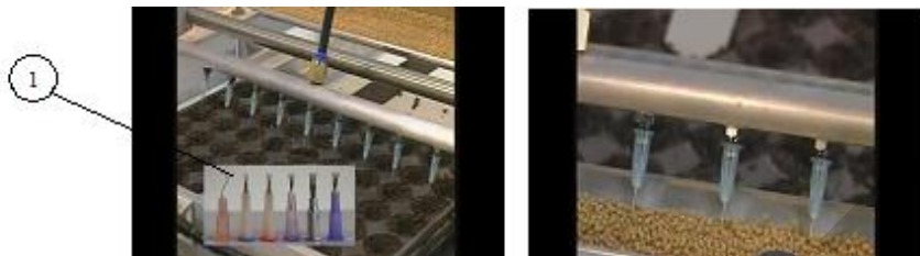
Рисунок 4. Общий вид игольчатого манипулятора для высева семян и набора сменных рабочих органов (1)
