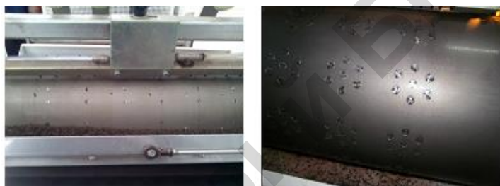
Рисунок 5. Общий вид высевающего барабана с групповым расположением присасывающих отверстий
