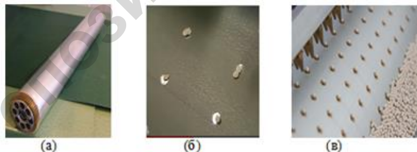
Рисунок 3. Общий вид высевающего барабана (а) и захваченных семян в отверстиях барабана (б, в)
