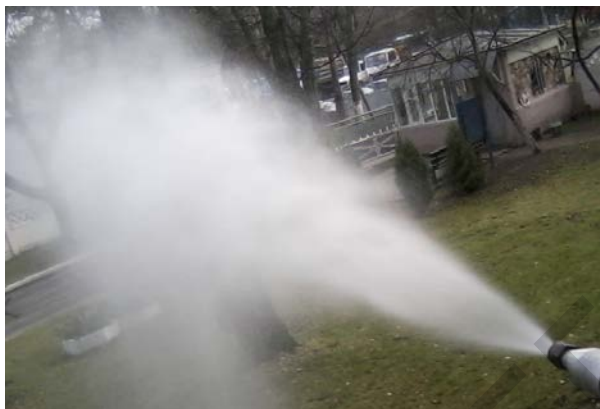
Рисунок 2 - Форма струи с максимальным углом распыления ( d_n=1,8\text{мм} , p\geq 12\text{МПа} )
