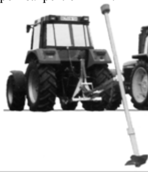
Рис. 2 – Миксер для перемешивания навоза в хранилищах
