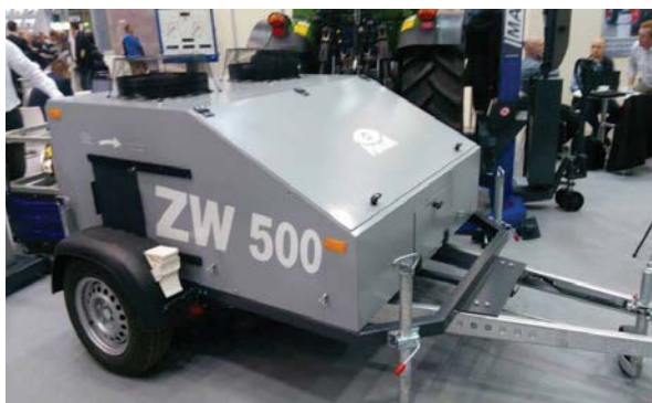
Рис. 1. Передвижной тормозной стенд ZW 500 с вихретоковым тормозом
