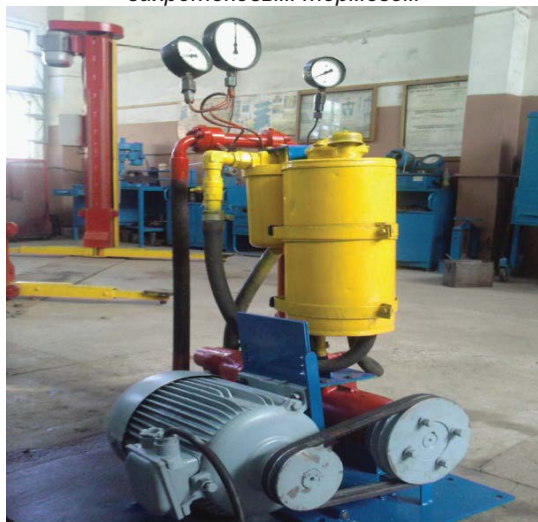
Рис. 2. Экспериментальный образец обкаточно-тормозного устройства мощностью до 120 кВт
