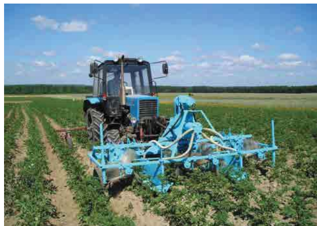
Рисунок 1. Комбинированный агрегат для сбора колорадского жука и окучивания картофеля в работе
