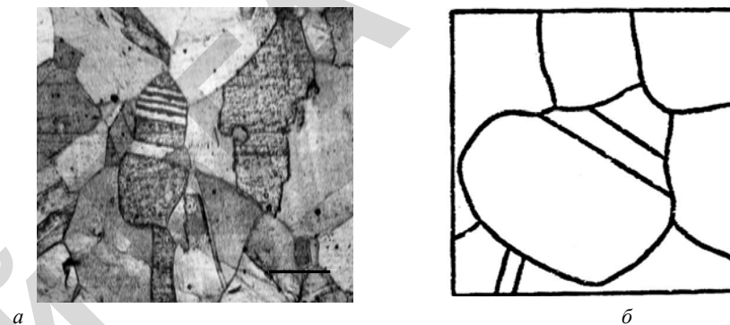
Рис. 9.2. Микроструктура деформированной и отожженной однофазной латуни Л80 (а), схема микроструктуры (б)
