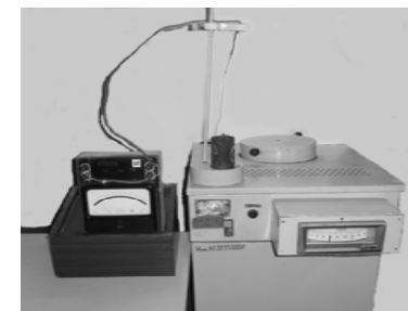
Рис. 4.2. Схема установки для исследования процесса кристаллизации сплавов методом термического анализа:
